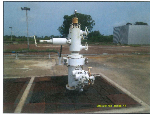
ภาพที่ 2-18 หลุมอัดกลับน้ำ BUR-A06 และ BUR-A08
